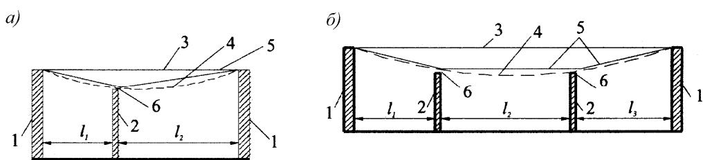
*a – одной в пролете; б – двух в пролете; 1 – несущие стены (или колонны); 2 – капитальные перегородки; 3 – перекрытие (покрытие) до приложения нагрузки; 4 – перекрытие (покрытие) после приложения нагрузки; 5 – линии отсчета прогибов; 6 – зазор*
